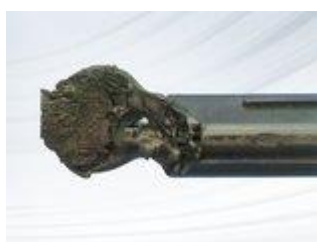
Questo danno è indice di un contatto indesiderato con l'impianto di scarico
