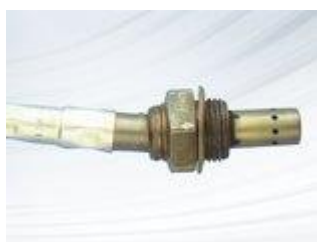
Una sonda piegata provoca una trasmissione difettosa del segnale.
